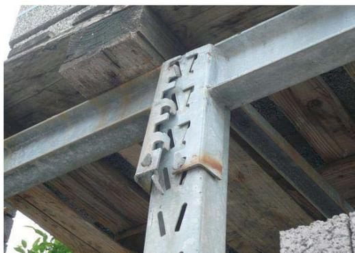
Trägereinhängung vermutlich beim Auslagern ausgerissen
